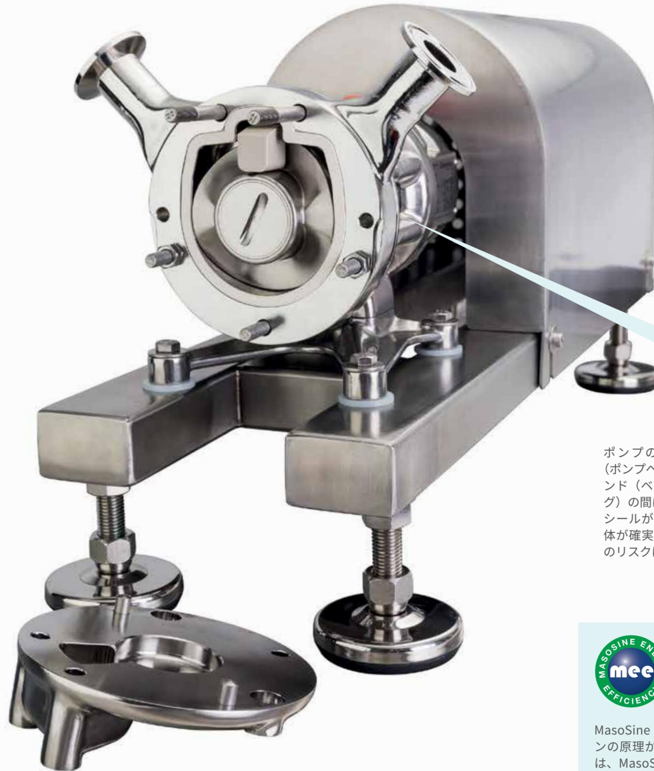
ポンプのウエットエンド（ポンプヘッド）とパワーエンド（ベアリングハウジング）の間に空間があるため、シールが破損した場合は流体が確実に排出され、汚染のリスクはありません。
