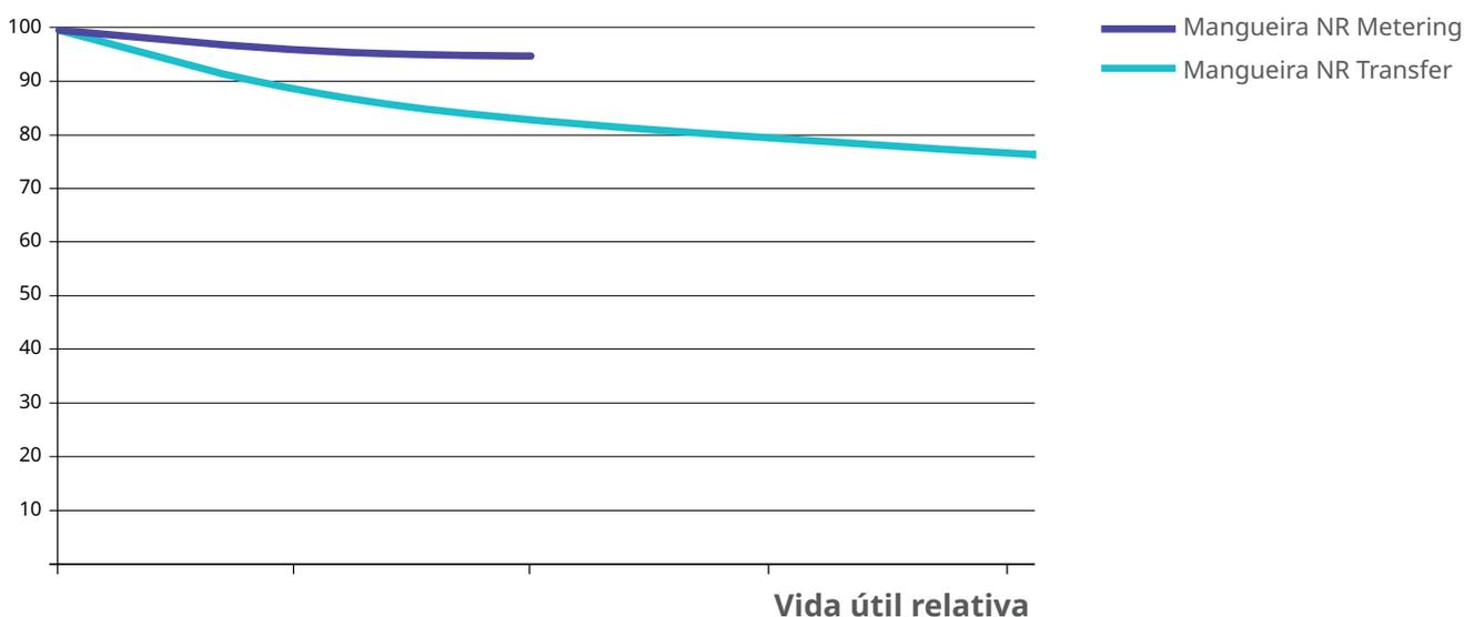
Condições típicas do teste de desempenho: bombagem de água a 18 °C (64 °F), 5 bar (73 psi) e 50 rpm
