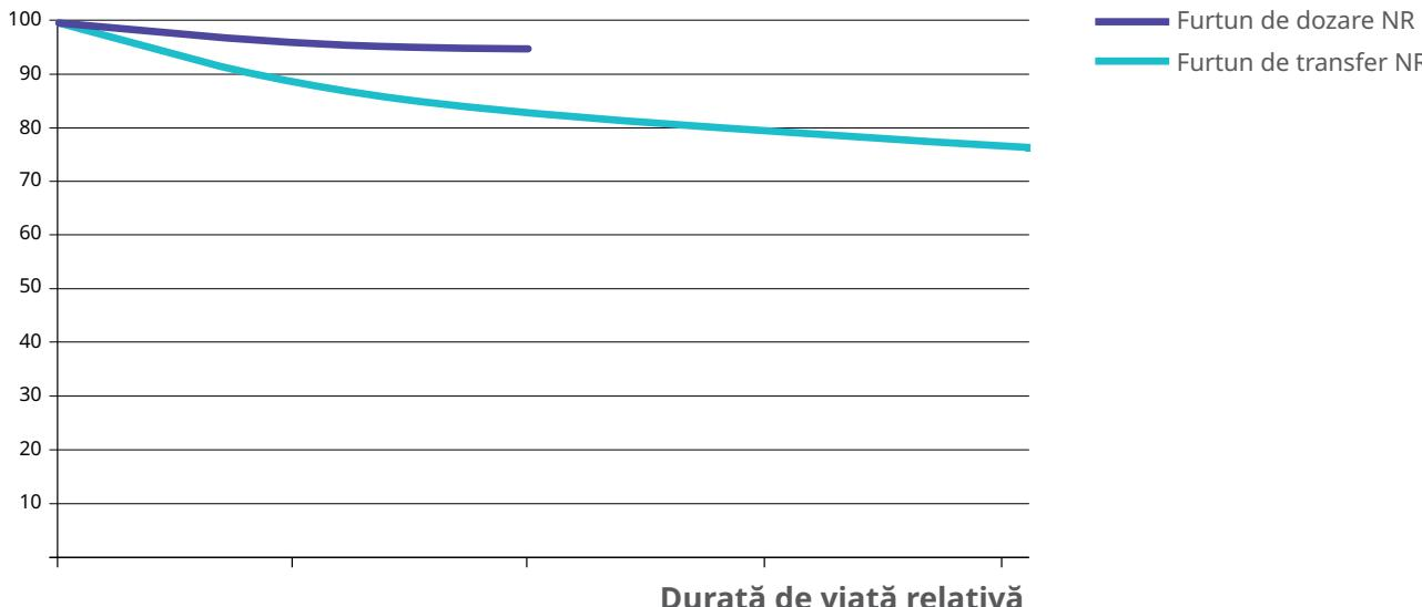
Condiții specifice de testare a performanțelor: pompare a apei la 18°C (64°F) la 5 bar (73 psi) și 50 rot/min
