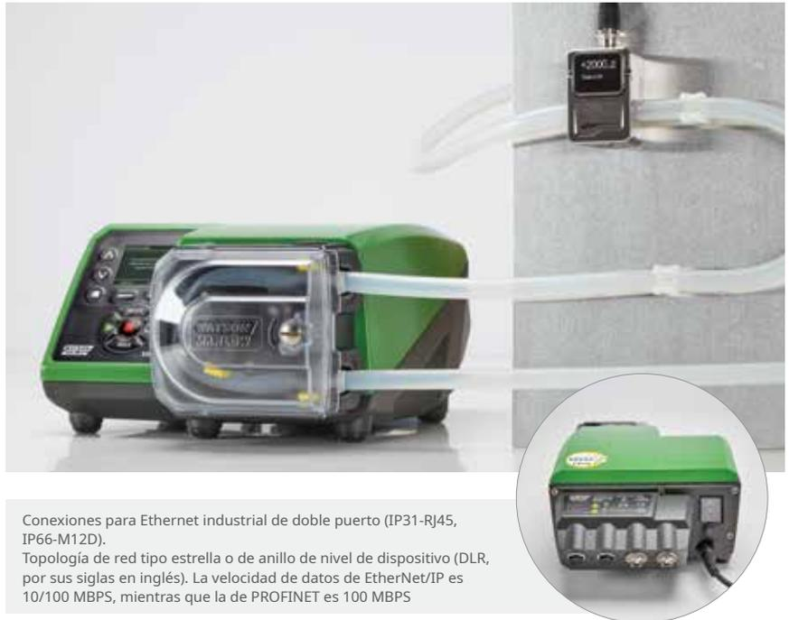
Conexiones para Ethernet industrial de doble puerto (IP31-RJ45, IP66-M12D). Topología de red tipo estrella o de anillo de nivel de dispositivo (DLR, por sus siglas en inglés). La velocidad de datos de EtherNet/IP es 10/100 MBPS, mientras que la de PROFINET es 100 MBPS
