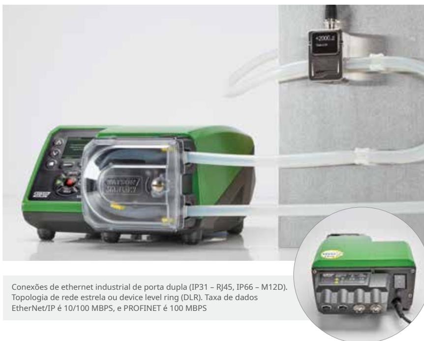
Conexões de ethernet industrial de porta dupla (IP31 – RJ45, IP66 – M12D). Topologia de rede estrela ou device level ring (DLR). Taxa de dados EtherNet/IP é 10/100 MBPS, e PROFINET é 100 MBPS
