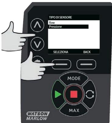
4. Viene visualizzato un elenco delle famiglie di sensori di portata supportati. L'esempio nell'immagine precedente mostra i sensori di portata supportati. Utilizzando i tasti  $\wedge$  /  $\vee$ , scorrere fino al sensore di portata desiderato e premere **SELEZIONA**.
