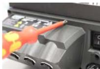
Figura 9 - Selettore di tensione
