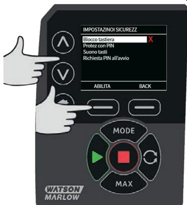
2. Una volta bloccata, apparirà la schermata seguente ogni volta che viene premuto un tasto. Per sbloccare la tastiera premere contemporaneamente i due tasti di **SBLOCCAGGIO**.
