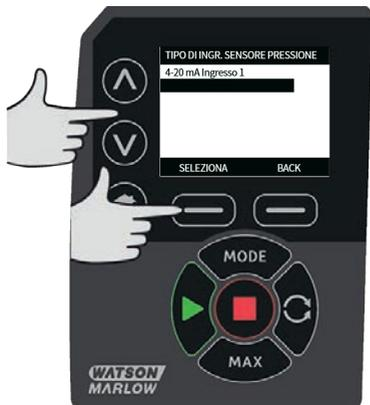
6. Utilizzando i tasti  $\wedge/\vee$ , selezionare il tipo di uscita per il sensore e premere **SELEZIONA**. Le opzioni nella tabella sottostante dipendono da tipo di sensore selezionato:
