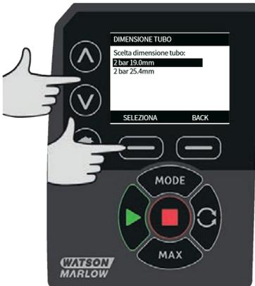
4. Questa schermata consente anche di selezionare il materiale del tubo utilizzato. Utilizzare i tasti  $\wedge$  /  $\vee$  per muovere la barra di selezione su **Materiale del tubo** e premere **SELEZIONA**.
