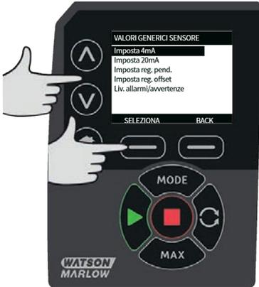
11. Utilizzando i tasti  $\wedge/\vee$ , modificare il valore riportato quando l'input del sensore è a 20 mA. Una volta ottenuto il valore desiderato, premere **SELEZIONA..**
