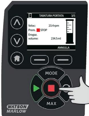
5. Utilizzare i tasti  $\wedge$   $\vee$  per inserire il volume effettivo di fluido pompato.
