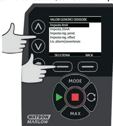
9. Utilizzando i tasti  $\wedge/\vee$ , modificare il valore riportato quando l'input del sensore è a 4 mA. Una volta ottenuto il valore desiderato, premere **SELEZIONA..**
