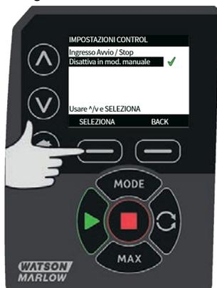
2. Utilizzare i tasti  $\wedge$  /  $\vee$  e premere **SELEZIONA** per scegliere lo stato logico dell'ingresso scelto per l'hardware di controllo collegato.
