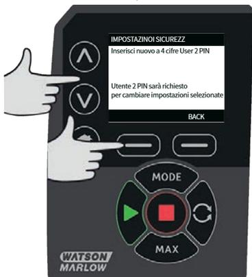
3. Per definire la funzionalità consentita, utilizzare i tasti  $\wedge$   $\vee$  per selezionare la funzionalità e premere **ABILITA**. Il PIN dell'Utente 2 consente l'accesso solo alle funzioni abilitate. Per disattivare una funzione, evidenziare la funzione abilitata e premere **DISABILITA**. Quando le funzioni richieste sono state abilitate, premere **TERMINA**.
