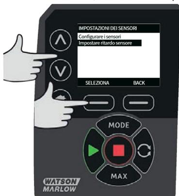
3. Utilizzando i tasti  $\wedge$  /  $\vee$ , scorrere fino all'opzione **Flusso** o **Pressione** e premere **SELEZIONA**. Questa operazione seleziona il tipo di sensore da configurare.
