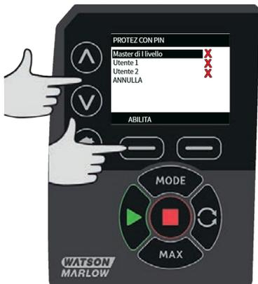
2. **ABILITA** le impostazioni di sicurezza per l'Utente 1 visualizza la schermata di inserimento del PIN per l'Utente 1. Per definire un 1 PIN a quattro cifre per l'Utente , usare i tasti  $\wedge$  /  $\vee$  per selezionare ogni cifra da 0 a 9. Una volta raggiunta la cifra desiderata, premere il tasto **CIFRA SUCCESSIVA**. Dopo avere selezionato la quarta cifra, premere **INVIO**.
