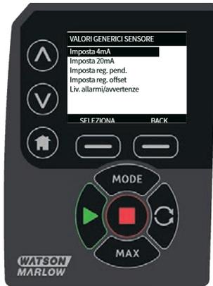
2. Utilizzando i tasti  $\wedge/\vee$ , scorrere fino a **Set slope adjust (Imposta regolazione pendenza)**
