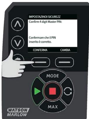
4. La schermata successiva verrà visualizzata per indicare che il PIN Master è stato applicato per accedere a tutte le funzioni. Premere **SUCC** per abilitare l'accesso a una funzione specifica per l'Utente 1 e l'Utente 2.
