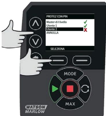
2. **ABILITA** le impostazioni di sicurezza per l'Utente 2 visualizza la schermata di inserimento del PIN per l'Utente 2. Per definire un 2 PIN a quattro cifre per l'Utente , usare i tasti **^** / **v** per selezionare ogni cifra da 0 a 9. Una volta raggiunta la cifra desiderata, premere il tasto **CIFRA SUCCESSIVA** Dopo aver selezionato la quarta cifra premere **INVIO**.
