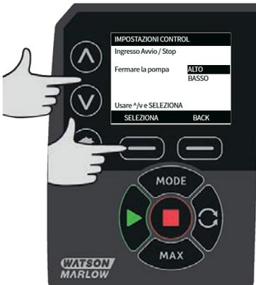
5. **NOTA:** Su questo modello, gli input 4 e 5 sono configurati per un sensore di pressione.
