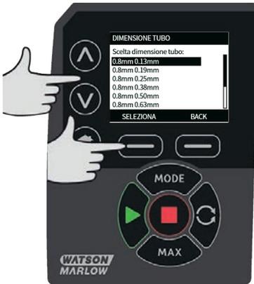
3. Se l'elemento LoadSure è stato selezionato, le dimensioni del tubo verranno visualizzate come pressione e diametro interno.
