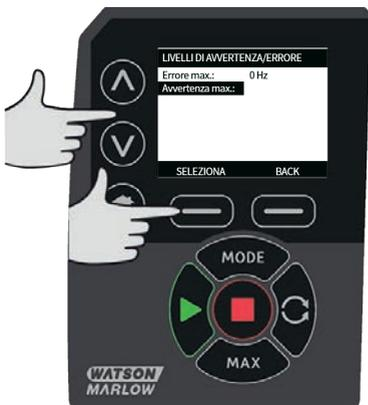
2. Utilizzando i tasti  $\wedge$  /  $\vee$ , inserire un valore e premere **SELEZIONA** per memorizzarlo. Questi parametri non hanno alcun valore predefinito. L'impostazione di un valore nelle schermate di modifica da parte dell'utente abilita l'allarme/l'avvertenza.
