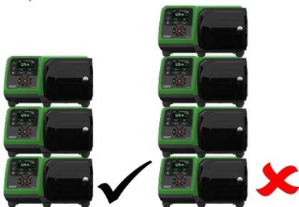
**Figura 2 - Impilaggio di pompe**
