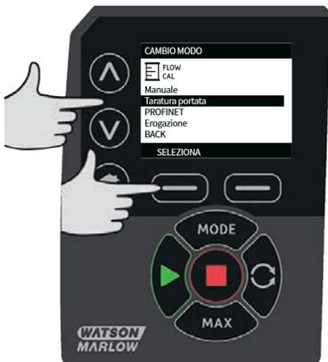
2. Utilizzando i tasti  $\wedge$  /  $\vee$ , inserire il limite massimo per la portata e premere **INVIO**.
