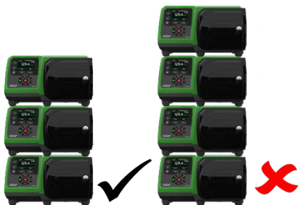
GF:图 1 -泵堆叠
