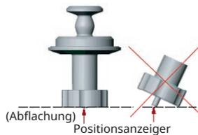
4. Nehmen Sie die Antriebs- und Membraneinheit aus dem Ventilkörper heraus. Ergreifen Sie hierzu die Membran am Rand und ziehen Sie sie nach unten aus dem Ventilkörper.
