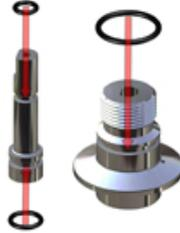
2. Schrauben Sie das obere Gehäuse auf die Hülse.
