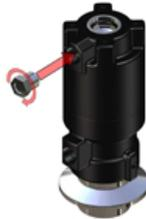
13. Schrauben Sie die Passschraube in die Baugruppe. Drücken Sie die Antriebswelle in Richtung des Pneumatikgehäuses, um sicherzustellen, dass die Antriebswellenabflachungen ausgerichtet verbleiben.
