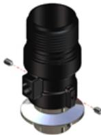
4. Setzen Sie den inneren O-Ring in die O-Ring-Nut ein.
