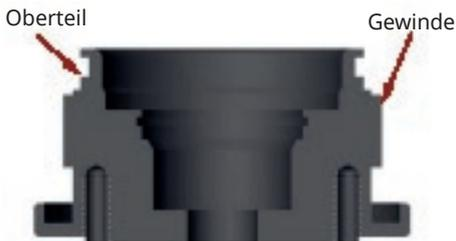
3. Entfernen Sie den Sprengring mit einer Sprengringzange aus der Mitte des Oberteils.
