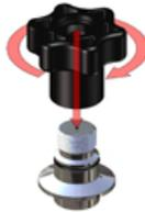
4. Setzen Sie den O-Ring in die Nut auf dem Griff ein.
