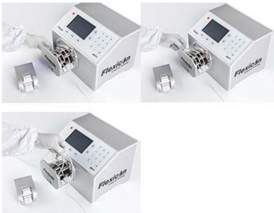
**Figura 11 - Remoção da mangueira do cabeçote**
