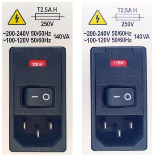
*Figura 14 - Seletor de tensão.*
