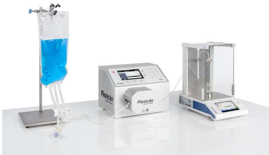
**Figura 42 - Montagem de conjunto com bomba PF7+, mangueira Asepticsu e o Kit avançado de envase da Flexicon**
