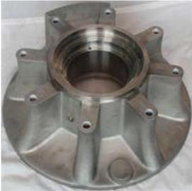
Parte de trás do alojamento posterior, mostrando o local onde o conjunto de vedação posterior do selo de vedação mecânico duplo será instalado.
