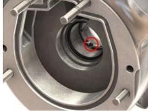
Coloque la junta tórica en el diámetro interno de la carcasa posterior
