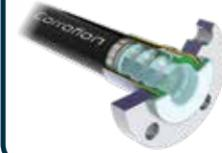
Corroflon 中的 PTFE 衬套具有浅卷，可最大限度地减少流量限制，外卷中的外部加强线可提供完全的真空阻力和扭结阻力
