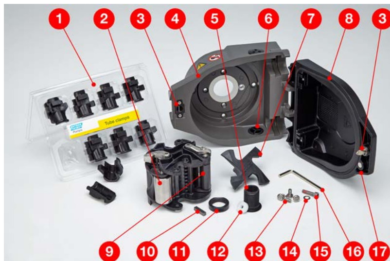
Figure 29 - Reservedele til pumpehoved 620RE, RE4 og 620R
