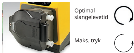
Figure 3 - Rotoromdrejningsretning
