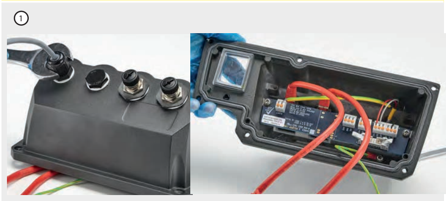
그림 10 -EtherNet/IP™ NEMA 모듈의 제어 케이블 접지 스크린
