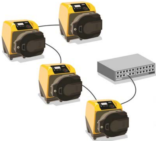
Afbeelding 20 - Lijntopologie
