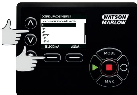
Se a unidade de vazão de massa for selecionada, a gravidade específica do fluido deverá ser informada. A seguinte tela será exibida:
