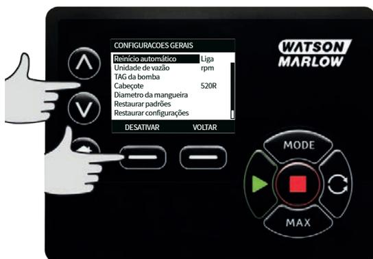
Use as teclas  $\wedge$  /  $\vee$  para ir até a barra de seleção acima de **Pumphead** (cabeçote) e pressione **SELECT** para selecionar.
