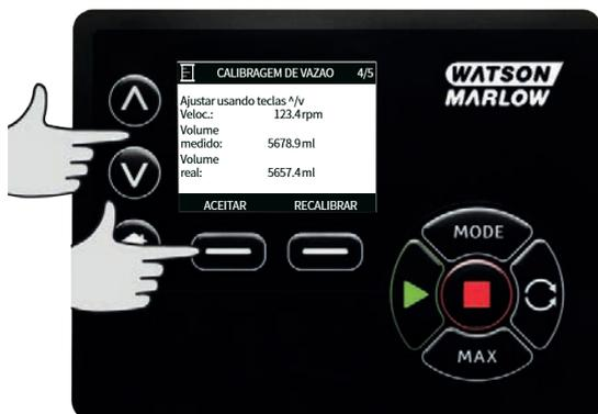
Para aceitar a nova calibração, pressione **ACCEPT** ou **RECALIBRATE** para calibrar novamente e repetir o procedimento. Pressione **HOME** ou **MODE** para cancelar.
