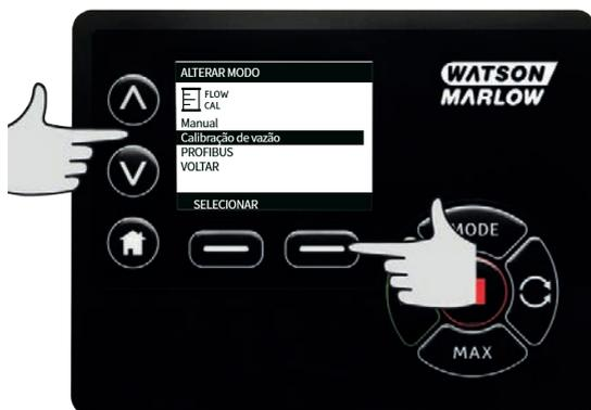
usando as teclas  $\wedge$  /  $\vee$ , digite o limite máximo de vazão e pressione **ENTER**.
