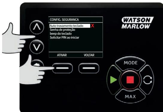
Uma vez bloqueado, será exibida a tela abaixo quando uma tecla for pressionada. Para desbloquear o teclado, pressione as duas teclas de desbloqueio (**UNLOCK**) ao mesmo tempo.
