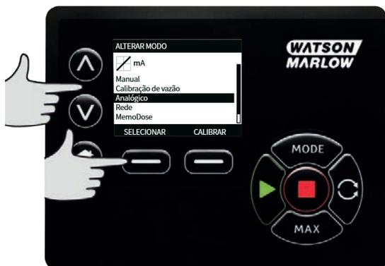
Use a tecla **SELECT** para selecionar o modo. Use a tecla de função da direita para alterar as configurações de modo.
