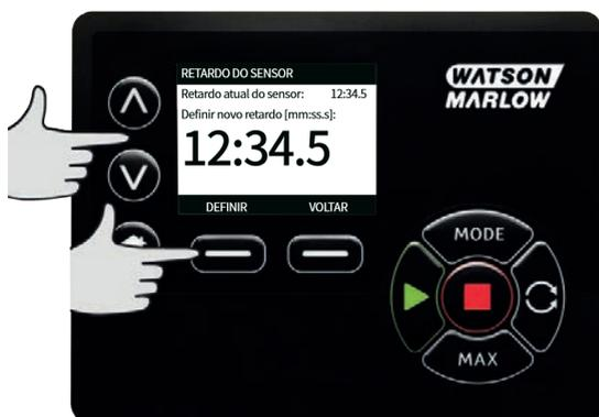
Usando as teclas  $\wedge$  /  $\vee$ , ajuste um valor e pressione **SELECT** para gravar.
