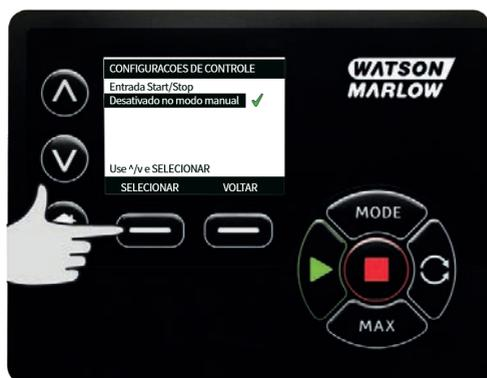
Use as teclas  $\wedge$  /  $\vee$  e pressione **SELECT** para escolher o estado de lógica da entrada selecionada para o hardware de controle conectado.
