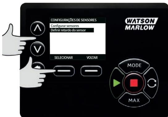
Usando as teclas  $\wedge$  /  $\vee$ , deslize até a opção **Configurar sensor** e pressione **SELECT**
