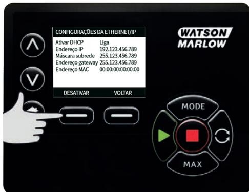
4. Pressione o botão de função 'DISABLE' (Desativar) para configurar 'DHCP Enable' (Ativar DHCP) para 'Off' (Desl).
