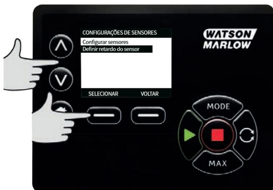
No menu de configurações de controle, use as teclas  $\wedge$  /  $\vee$  para navegar até a opção **Ajustar atraso do sensor** e pressione **SELECT**
