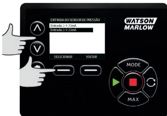
Usando as teclas  $\wedge$  /  $\vee$ , deslize até a opção **4-20 mA entrada 1** ou **4-20 mA entrada 2** e pressione **SELECT**.
