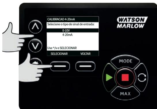
A bomba oferece a opção de entrada manual dos sinais mA ou V alto e baixo ou através de entrada analógica. A entrada dos valores em mA está descrita aqui. Contudo, o processo para entrada de sinais em V é idêntico.
