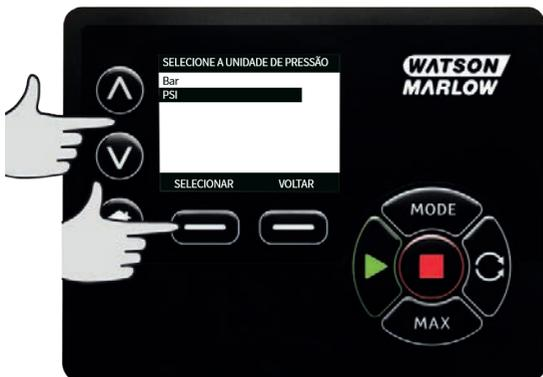
Usando as teclas  $\wedge$  /  $\vee$ , selecione o tipo de unidade de saída do sensor e pressione **SELECT**. As opções na tabela abaixo dependem da escolha do tipo de sensor:
