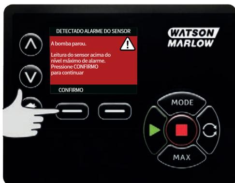
Quando uma faixa de alarme for disparada, a bomba exibirá na tela "alarme de sensor detectado" e a bomba deixará de funcionar.
