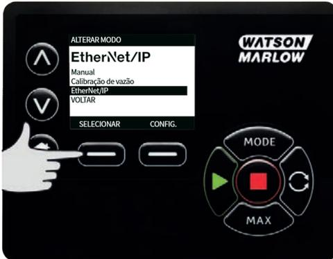
1. No menu MODE, realce EtherNet/IP e pressione SELECT para selecionar o modo EtherNet/IP™.
