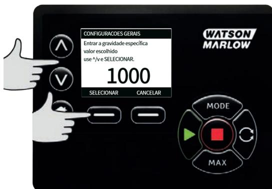
Use as teclas  $\wedge$   $\vee$  para digitar o valor da gravidade específica e pressione **SELECT** para selecionar.
