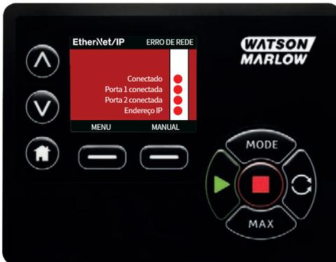
2. A tela da bomba irá indicar um erro de rede (como mostrado acima) se a bomba não estiver conectada a um computador.
