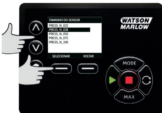
Usando as teclas  $\wedge$  /  $\vee$ , deslize até o tamanho do sensor desejado e pressione **SELECT**.
