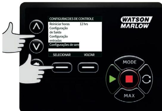
No menu de configurações de controle, use as teclas  $\wedge$  /  $\vee$  para navegar até a opção **Configurações do sensor** e pressione **SELECT**
