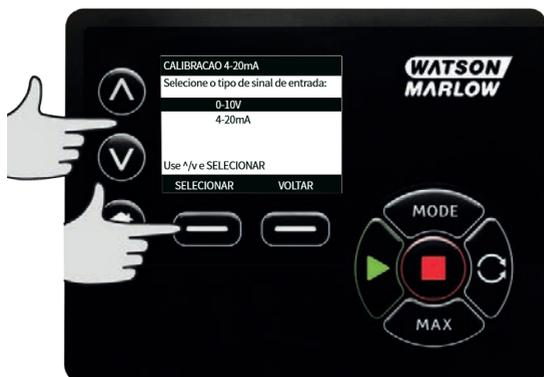
A bomba oferece a opção de entrada manual dos sinais mA ou V alto e baixo ou através de entrada analógica. A entrada dos valores em mA está descrita aqui. O processo para entrada de sinais em V é idêntico.
