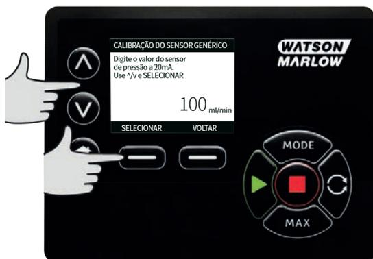
Usando as teclas  $\wedge$  /  $\vee$ , mude os valor mostrado quando a entrada do sensor for de 20mA. Ao atingir o valor desejado pressione **SELECT**.
