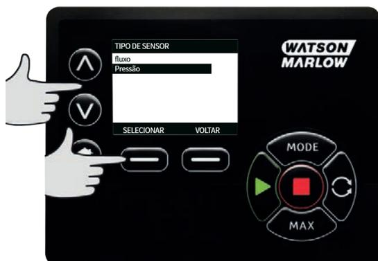
Usando as teclas  $\wedge$  /  $\vee$ , deslize até a opção **Vazão** ou **Pressão** e pressione SELECT. Isto seleciona o tipo de sensor para configurar.
