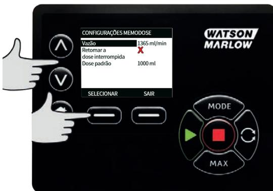
Usando as teclas  $\wedge$ / $\vee$ , digite a vazão e pressione **SELECT** para selecionar.
