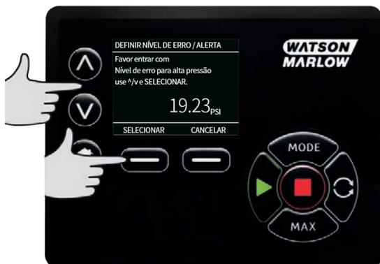
Usando as teclas  $\wedge$  /  $\vee$ , digite um valor e pressione **SELECT** para gravar.
