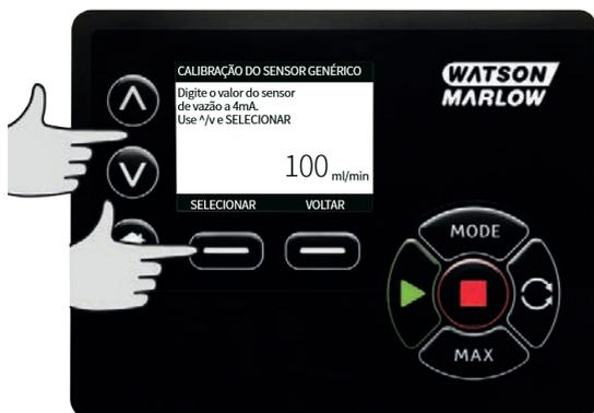
Usando as teclas  $\wedge$  /  $\vee$ , mude os valor mostrado quando a entrada do sensor for de 4 mA. Ao atingir o valor desejado pressione **SELECT**.
