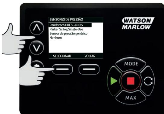
Usando as teclas  $\wedge$  /  $\vee$ , deslize até a opção **Sensor de vazão genérico** ou **Sensor de pressão genérico** e pressione **SELECT**.
