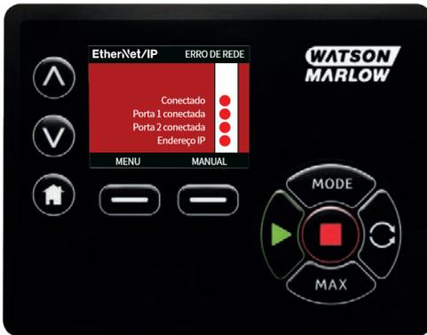
2. Os indicadores 'Connected' e 'Port 1 Connected' ou 'Port 2 Connected' ficarão verdes e serão seguidos pelo 'IP Address' (Endereço de IP). A bomba entrará então no modo EtherNet/IP™.
