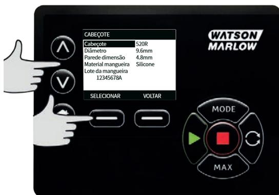
Use as teclas  $\wedge$  /  $\vee$  para ir até a barra de seleção acima do tipo de cabeçote necessário e pressione **SELECT** para selecionar.
