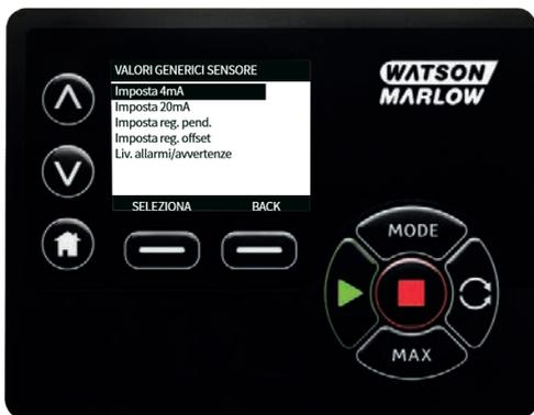
2. Utilizzando i tasti  $\wedge/\vee$ , scorrere fino a **Set slope adjust (Imposta regolazione pendenza)**
