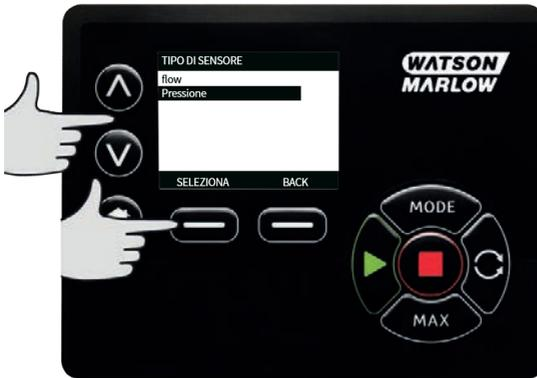
4. Utilizzando i tasti  $\wedge/\vee$ , scorrere fino all'opzione **Sensore di portata generico** o **Sensore di pressione generico** e premere **SELEZIONA**.
