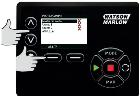
2. **ABILITA** le impostazioni di sicurezza per l'Utente 1 visualizza la schermata di inserimento del PIN per l'Utente 1. Per definire un 1 PIN a quattro cifre per l'Utente , usare i tasti  $\wedge$  /  $\vee$  per selezionare ogni cifra da 0 a 9. Una volta raggiunta la cifra desiderata, premere il tasto **CIFRA SUCCESSIVA**. Dopo avere selezionato la quarta cifra, premere **INVIO**.
