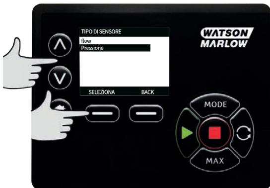
4. Viene visualizzato un elenco delle famiglie di sensori di portata supportati. L'esempio nell'immagine precedente mostra i sensori di portata supportati. Utilizzando i tasti  $\wedge$  /  $\vee$ , scorrere fino al sensore di portata desiderato e premere **SELEZIONA**.
