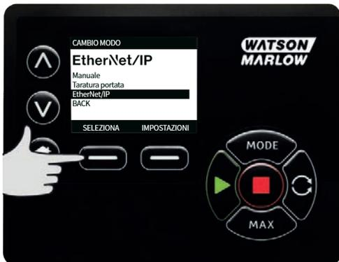
2. Se la pompa non è collegata ad un PC, il display della pompa mostrerà l'errore di rete sopra indicato.
