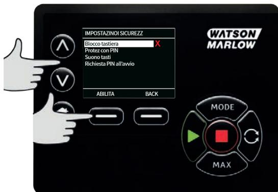
2. Una volta bloccata, apparirà la schermata seguente ogni volta che viene premuto un tasto. Per sbloccare la tastiera premere contemporaneamente i due tasti di **SBLOCCAGGIO**.
