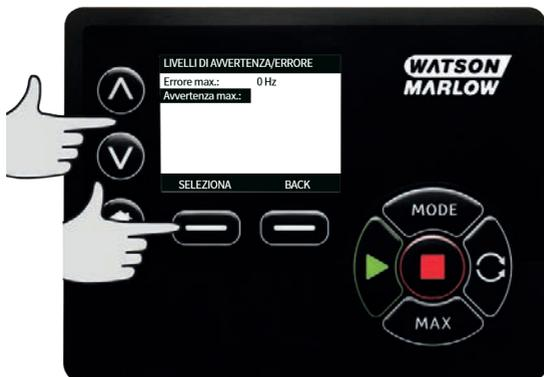
2. Utilizzando i tasti  $\wedge$  /  $\vee$ , inserire un valore e premere **SELEZIONA** per memorizzarlo. Questi parametri non hanno alcun valore predefinito. L'impostazione di un valore nelle schermate di modifica da parte dell'utente abilita l'allarme/l'avvertenza.
