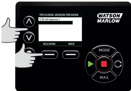
6. Utilizzando i tasti  $\wedge/\vee$ , selezionare il tipo di uscita per il sensore e premere **SELEZIONA**. Le opzioni nella tabella sottostante dipendono da tipo di sensore selezionato:
