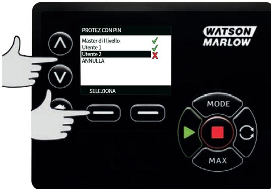
2. **ABILITA** le impostazioni di sicurezza per l'Utente 2 visualizza la schermata di inserimento del PIN per l'Utente 2. Per definire un 2 PIN a quattro cifre per l'Utente , usare i tasti **^** / **v** per selezionare ogni cifra da 0 a 9. Una volta raggiunta la cifra desiderata, premere il tasto **CIFRA SUCCESSIVA** Dopo aver selezionato la quarta cifra premere **INVIO**.
