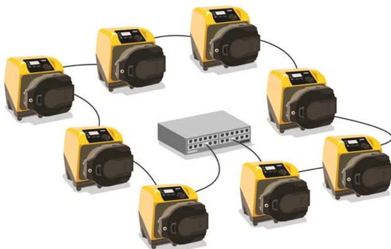
rys. 19 - Pierścień
