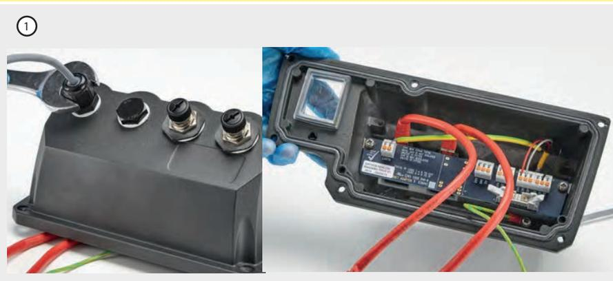
Schermatura del cavo di comando collegata al terminale di terra (J6) sul PCB adattatore quando si utilizza il serracavo in plastica.
