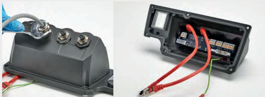
Figure 10 - Jordskærmning af styrekabler på PROFINET® NEMA-modul
