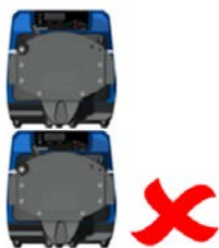
rys. 2 - Układanie pomp w stos
