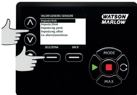
9. Utilizzando i tasti  $\wedge/\vee$ , modificare il valore riportato quando l'input del sensore è a 4 mA. Una volta ottenuto il valore desiderato, premere **SELEZIONA**.
