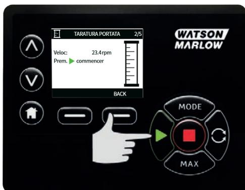
4. Premere **STOP** per fermare il pompaggio del liquido per la taratura.
