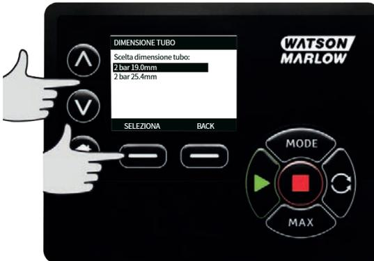
4. Questa schermata consente anche di selezionare il materiale del tubo utilizzato. Utilizzare i tasti  $\wedge$  /  $\vee$  per muovere la barra di selezione su **Materiale del tubo** e premere **SELEZIONA**.
