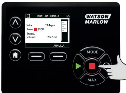
5. Utilizzare i tasti  $\wedge$  /  $\vee$  per inserire il volume effettivo di fluido pompato.
