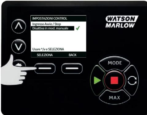
2. Utilizzare i tasti  $\wedge$  /  $\vee$  e premere **SELEZIONA** per scegliere lo stato logico dell'ingresso scelto per l'hardware di controllo collegato.
