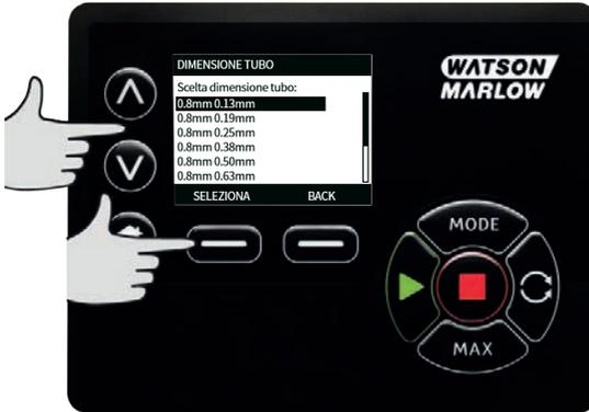
3. Se l'elemento LoadSure è stato selezionato, le dimensioni del tubo verranno visualizzate come pressione e diametro interno.
