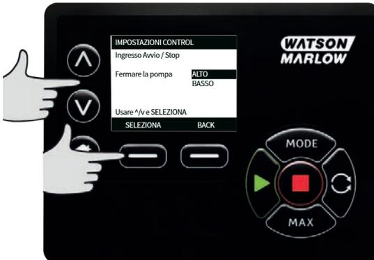
5. **NOTA:** Su questo modello, gli input 4 e 5 sono configurati per un sensore di pressione.
