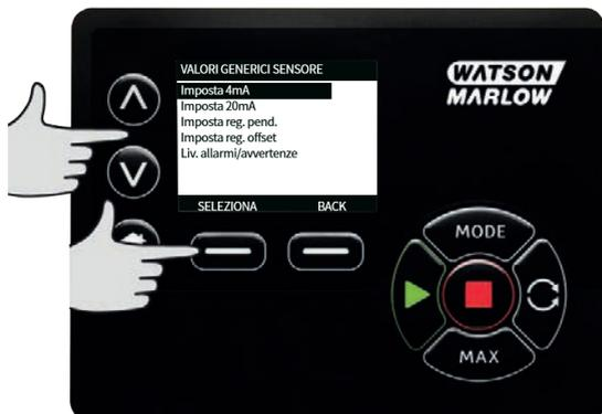
11. Utilizzando i tasti  $\wedge/\vee$ , modificare il valore riportato quando l'input del sensore è a 20 mA. Una volta ottenuto il valore desiderato, premere **SELEZIONA..**
