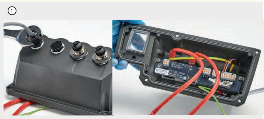
그림 10 -EtherNet/IP™ NEMA 모듈의 제어 케이블 접지 스크린
