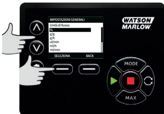
Se viene selezionata un'unità di portata di massa, sarà necessario inserire la gravità specifica del fluido. Verrà visualizzata la schermata seguente.
