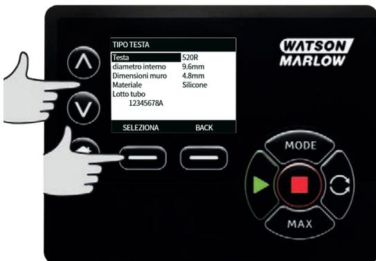
Usare i tasti  $\wedge$  /  $\vee$  per spostare la barra di selezione sul materiale del tubo da usare e premere **SELEZIONA**.
