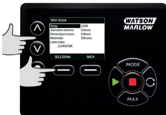
Usare i tasti  $\wedge$  /  $\vee$  per spostare la barra di selezione sulle dimensioni del tubo da usare e premere **SELEZIONA**.
