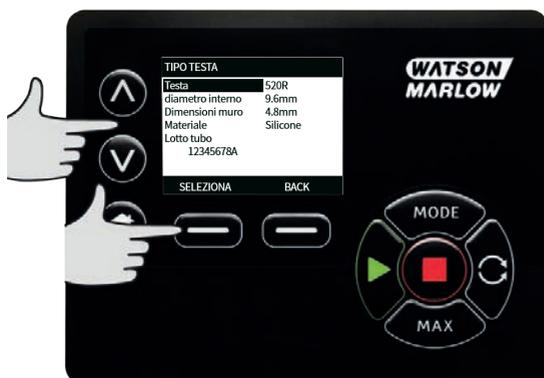
Usare i tasti  $\wedge$  /  $\vee$  per spostare la barra di selezione sul tipo di testa pompa desiderato e premere **SELEZIONA**.
