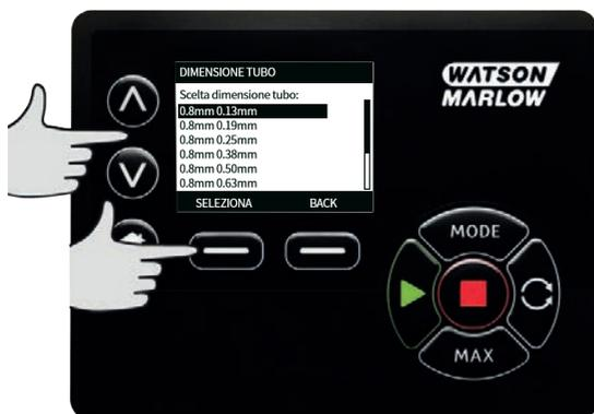
Se l'elemento LoadSure è stato selezionato, le dimensioni del tubo verranno visualizzate come pressione e diametro interno.
