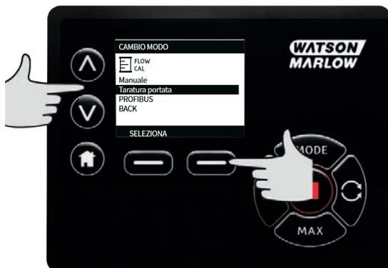
Con i tasti  $\wedge$ / $\vee$ , inserire il limite di portata massimo e premere **ENTER**.
