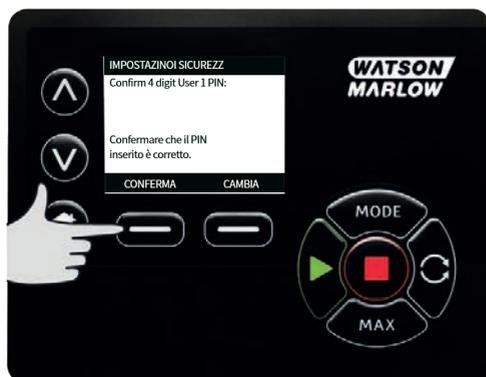
Per definire la funzione consentita, usare i tasti  $\wedge$  /  $\vee$  per selezionare la funzione e premere **ABILITA**. Il PIN dell'Utente 1 consente l'accesso solo alle funzioni abilitate. Per disattivare una funzione, evidenziare la funzione abilitata e premere **DISABILITA**. Quando le funzioni richieste sono state abilitate, premere **TERMINA**.
