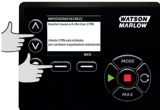
Per definire la funzione consentita, usare i tasti  $\wedge$  /  $\vee$  per selezionare la funzione e premere **ABILITA**. Il PIN dell'Utente 2 consente l'accesso solo alle funzioni abilitate. Per disattivare una funzione, evidenziare la funzione abilitata e premere **DISABILITA**. Quando le funzioni richieste sono state abilitate, premere **TERMINA**.
