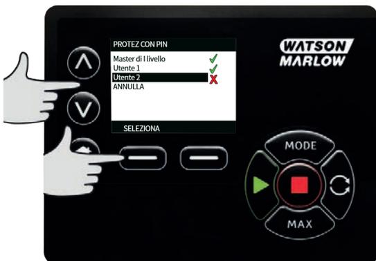
ABILITA le impostazioni di sicurezza per l'Utente 2 visualizza la schermata di inserimento del PIN per l'Utente 2. Per definire un PIN a quattro cifre per l'Utente 2, usare i tasti  $\wedge$  /  $\vee$  per selezionare ogni cifra da 0 a 9. Una volta raggiunta la cifra desiderata, premere il tasto **CIFRA SUCCESSIVA**. Dopo aver selezionato la quarta cifra premere **INVIO**.
