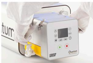
Finalmente, cierre las asas de la pista Quantum en el cabezal. Asegúrese de que la pista esté bien sujeta y bloqueada.
