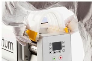
Levante el cartucho y sáquelo del cabezal.
