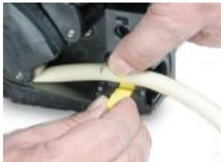
15. 로터 허브 한쪽의 노란색 클러치 버튼을 완전히 누르고 클러치 버튼을 여전히 누른 상태에서 허브를 몇 도쯤 돌려서 로터 클러치를 해제합니다. 이제 로터는 기어박스 및 모터와 독립적으로 완전히 한 바퀴 회전할 수 있습니다. 튜브 결합을 완료하기 전에 클러치를 다시 맞물리고, 클러치 버튼을 다시 누르고, 로터를 몇 도쯤 돌립니다.
