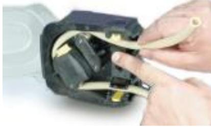
9. 튜브가 펌프헤드를 드나들지 않을 정도로 스프링 로딩 튜브 클램프가 튜브를 단단히 잡고 있는지 확인하십시오. 단 튜브를 과도하게 압착하지 않게 주의하십시오. 몇 번의 로터 시험 회전 시 튜브가 움직이지 않도록 슬라이더를 조정하십시오. 바깥쪽 부분은 클램프가 튜브를 단단히 고정하고, 안쪽 부분은 튜브를 느슨하게 고정합니다
