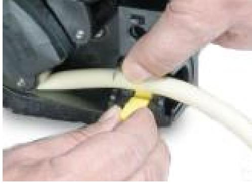
6. 로터 허브 한쪽의 노란색 클러치 버튼을 완전히 누르고 클러치 버튼을 여전히 누른 상태에서 허브를 몇 도쯤 돌려서 로터 클러치를 해제합니다. 이제 로터는 기어박스 및 모터와 독립적으로 완전히 한 바퀴 회전할 수 있습니다. 튜브 결합을 완료하기 전에 클러치를 다시 맞물리고, 클러치 버튼을 다시 누르고, 로터를 몇 도쯤 돌립니다.
