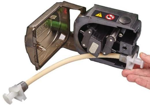
5. 로터 허브 한쪽의 노란색 클러치 버튼을 완전히 누르고 클러치 버튼을 여전히 누른 상태에서 허브를 몇 도쯤 돌려서 로터 클러치를 해제합니다. 이제 로터는 기어박스 및 모터와 독립적으로 완전히 한 바퀴 회전할 수 있습니다. 튜브 결합을 완료하기 전에 클러치를 다시 맞물리고, 클러치 버튼을 다시 누르고, 로터를 몇 도쯤 돌립니다.
