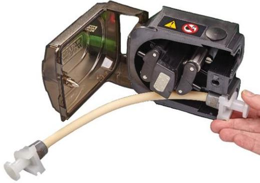
7. 로터 허브 한쪽의 노란색 클러치 버튼을 완전히 누르고 클러치 버튼을 여전히 누른 상태에서 허브를 몇 도쯤 돌려서 로터 클러치를 해제합니다. 이제 로터는 기어박스 및 모터와 독립적으로 완전히 한 바퀴 회전할 수 있습니다. 튜브 결합을 완료하기 전에 클러치를 다시 맞물리고, 클러치 버튼을 다시 누르고, 로터를 몇 도쯤 돌립니다.
