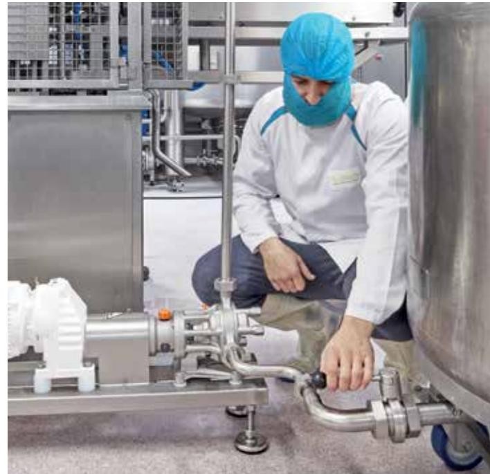
MasoSine Certa 泵在关键的食品饮料应用中的表现优于凸轮泵。MasoSine 泵的正弦型转子设计使剪切力较小，泵送更温和，可安全地输送易碎食品，没有变质风险。
