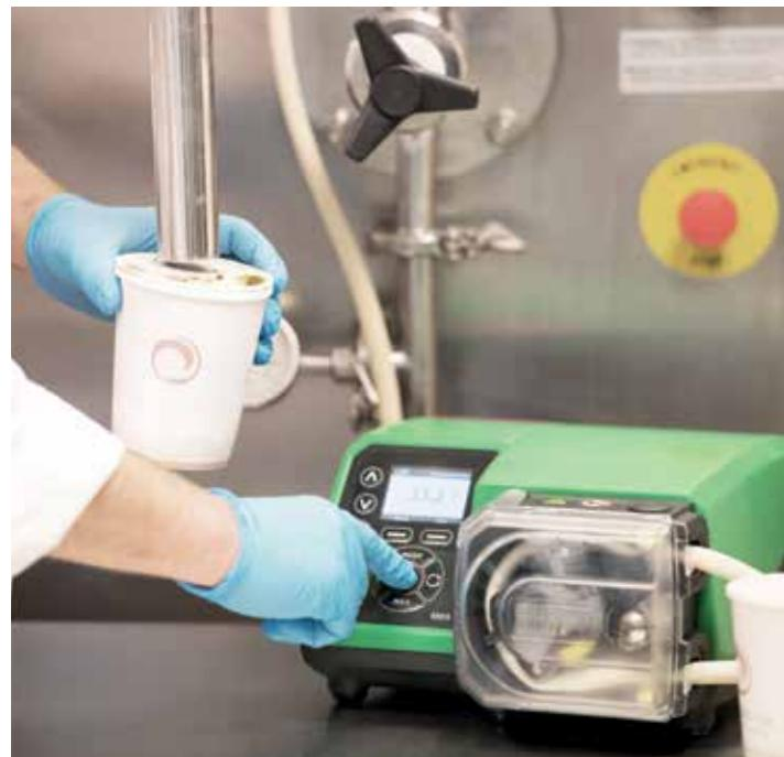
蠕动泵可以处理腐蚀性和剪切敏感流体。泵送的流体完全包含在软管内，可完全隔离流体且无交叉污染。
